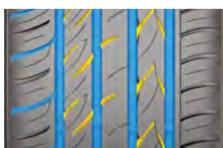
Многочисленные бороздки в сочетании с открытой внутренней плечевой зоной и широкими каналами по всей окружности обеспечивают отличное отведение воды и улучшают сцепление и торможение на мокрой дороге.
