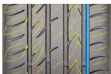
Оптимизированный рисунок протектора с усиленными поперечными связями гарантирует хорошую управляемость и равномерное распределение давления в пятне контакта. Это улучшает характеристики на извилистых дорогах и обеспечивает надежное торможение.
