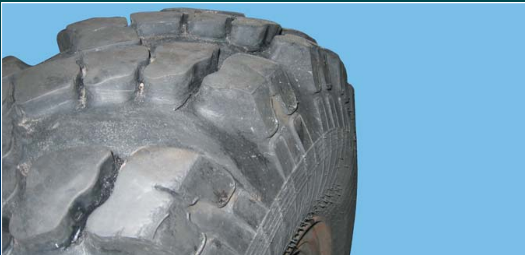
Трещина по дну канавки
