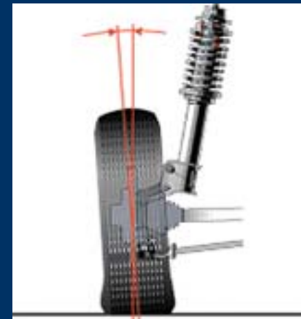
«Развал» передних колёс автомобиля
