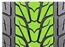
Улучшенные тормозные характеристики и управляемость на высоких скоростях на мокрой дороге благодаря превосходным дренажным свойствам направленного рисунка
