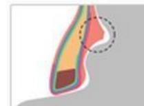
Защитный кант предохраняет обод диска от повреждения при наезде на препятствие, а также уменьшает вероятность разрыва корда каркаса при наезде на препятствие или попадание в яму
