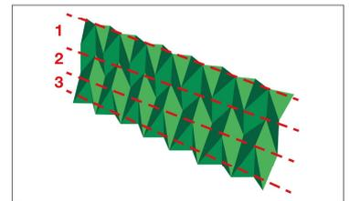
3D-ламели сохраняют упругость блоков протектора на сухой поверхности, способствуют снижению износа шины благодаря отличному кромочному эффекту, а также способствуют лучшей управляемости на заснеженной и мокрой поверхности
