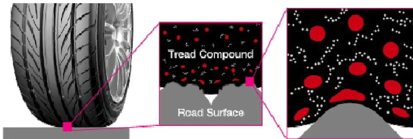
Новый микроэластичный состав повторяет неровности дороги и увеличивает площадь пятна контакта шины и дорожного покрытия.
