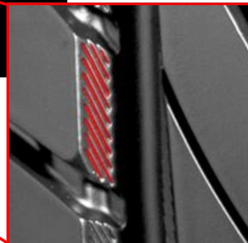
Канавка-в-канавке эффективно распределяет стресс нагрузки при движении и минимизирует износ
